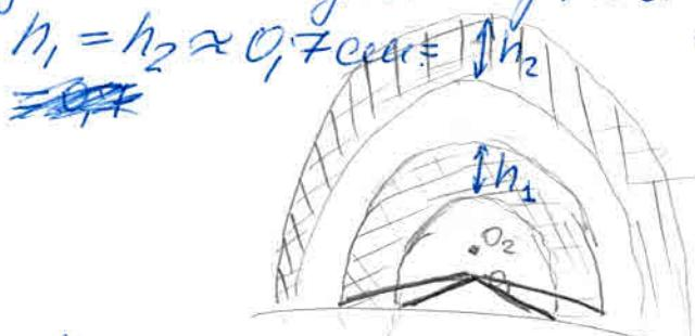
Для того, чтобы вычислить площадь пятныш из пятныш, опирающиеся на них края концентрических окружностей. Внутренний дуга хорошо приближается окружностью
