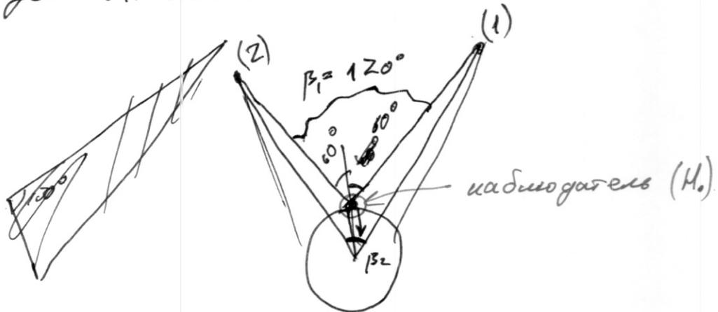
Т.к. спутники довольно далеко, то  $\beta_1 \geq \beta_2$  и из этого следует, что спутников в 1 плоскости  $n_1 = \frac{360^{\circ}}{\beta_2} \geq \frac{360^{\circ}}{\beta_1} \Rightarrow$
